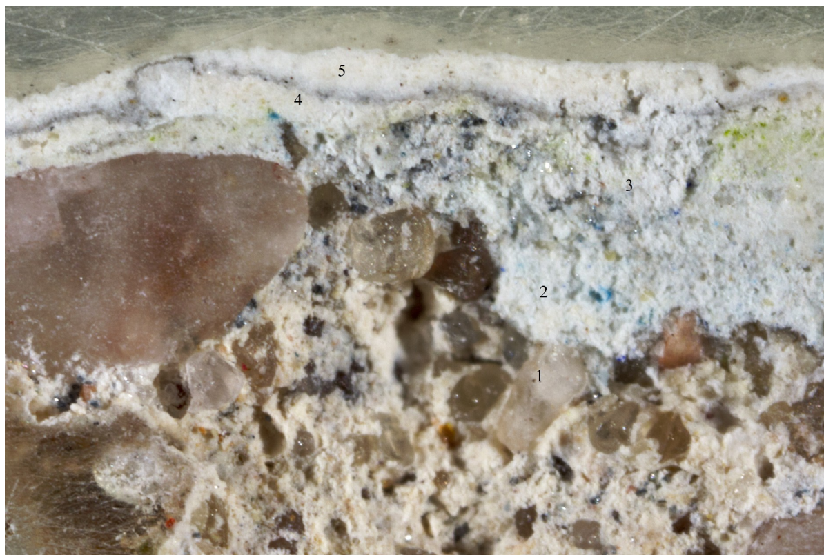
Fot. 22. Widok naszlifu Próbki 7 pobranej z Odkrywki nr 5 . Widoczna stratygrafia nawarstwień: 1 – tynk, 2 - niebieskawa, 3 – szarawa, 4 – żółtawa z brudem na powierzchni, 5 - żółtawa.
