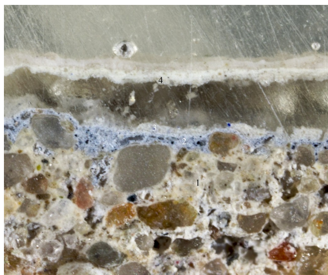
Fot. 39. Widok naszlifu Próbki 17 pobranej z Odkrywki nr 14 . Widoczna stratygrafia nawarstwień: 1 – tynk, 2 – szara cementowa, 3 – szarawa, 4 – kremowa.
