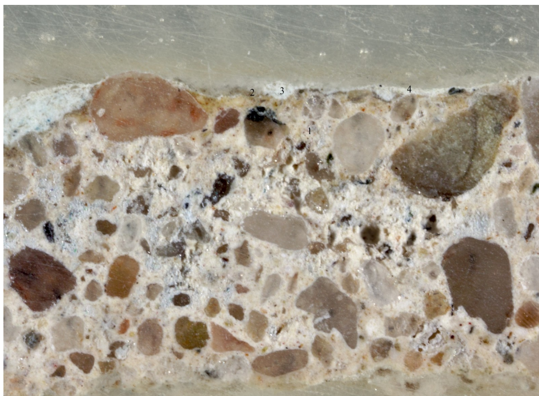
Fot. 37. Widok naszlifu Próbki 16 pobranej z Odkrywki nr 13 . Widoczna stratygrafia nawarstwień: 1 – tynk, 2 – ciemnoszara, 3 – niebieskawa, 4 – kremowa.
