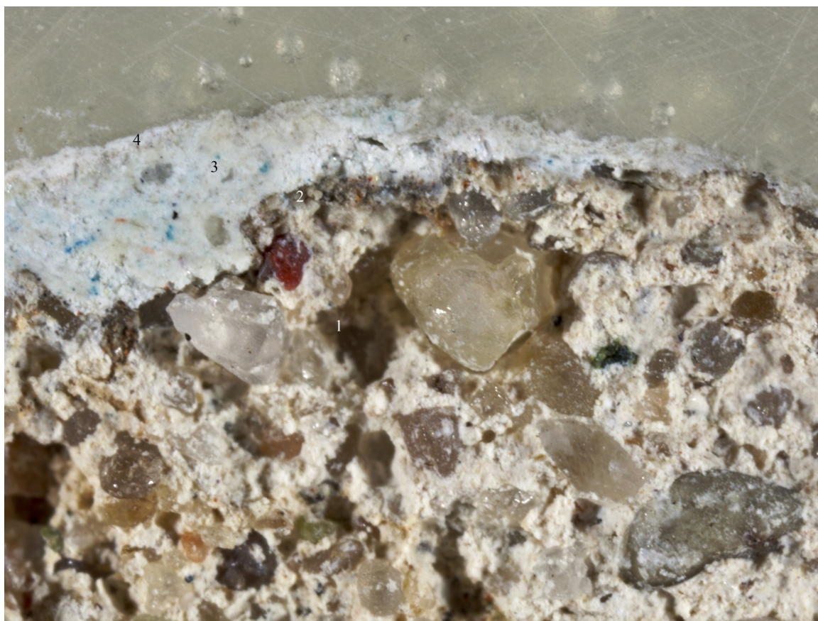
Fot. 13. Widok naszlifu Próbki 1 pobranej z Odkrywki nr 1 . Widoczna stratygrafia nawarstwień: 1 – tynk, 2 – przeklejenie (zagruntowanie) lub brud, 3 – niebieskawa, 4 – kremowa. Kolorystyka elewacji była barwy tynku.
