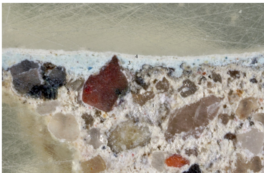
Fot. 17. Widok naszlifu Próbki 3 pobranej z Odkrywki nr 3 . Widoczna stratygrafia nawarstwień: 1 – tynk, 2 – przeklejenie (zagruntowanie) lub brud, 3 – niebieskawa, 4 – kremowa. Kolorystyka elewacji była barwy tynku.
