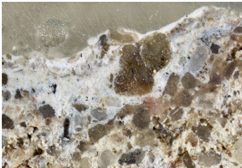
Fot. 24. Widok naszlifu Próbki 8 pobranej z Odkrywki nr 6 . Widoczna stratygrafia nawarstwień: 1 – tynk, 2 – szarawa, 3 – biała, 4 – biała. Tynk fakturalny leży na zagładzanym tynku podkładowym
