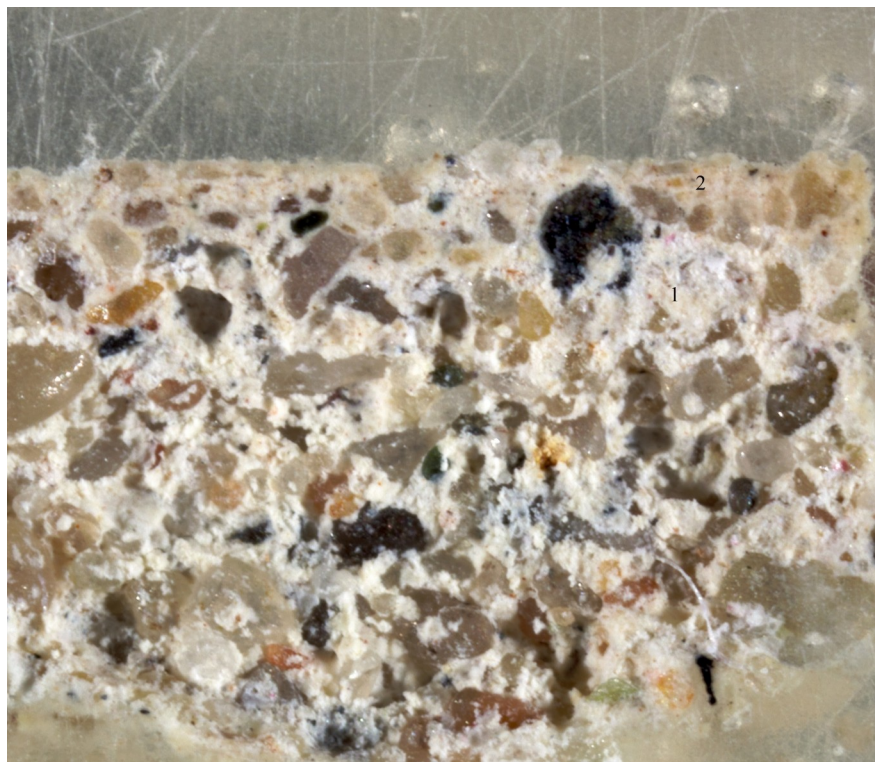
Fot. 26. Widok naszlifu Próbki 9 pobranej z Odkrywki nr 7 . Widoczna stratygrafia nawarstwień: 1 – tynk spodni, 2 – żółtawa powierzchnia. Przypuszczalnie najstarsza kolorystyka budynku przed rozbudową.
