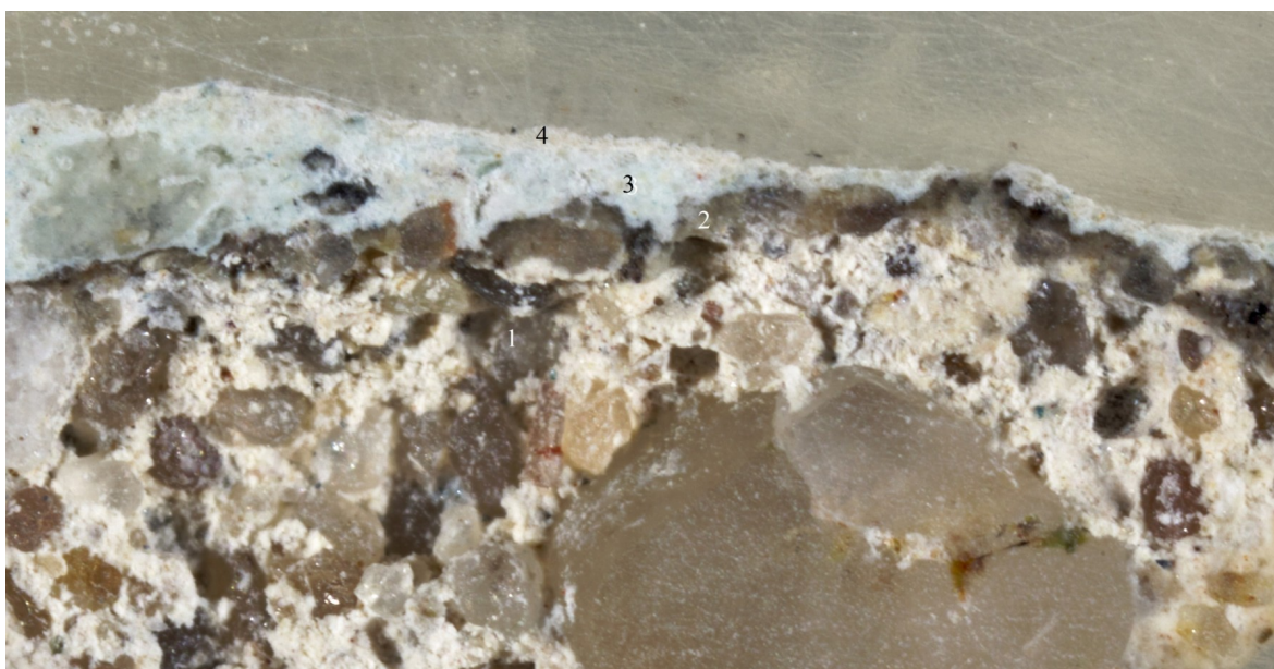
Fot. 15. Widok naszlifu Próbki 2 pobranej z Odkrywki nr 2 . Widoczna stratygrafia nawarstwień: 1 – tynk, 2 – przklejenie (zagruntowanie) lub brud, 3 – niebieskawa, 4 – kremowa.
